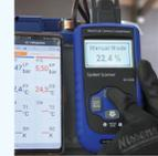
**CONSEILS :** UTILISEZ UN TESTEUR ECV POUR INSPECTER LE FONCTIONNEMENT DU COMPRESSEUR VARIABLE/ECV
